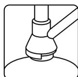
Coloque e centralize o adaptador da válvula. Se a válvula se encaixa com dificuldade, então ela está com defeito!
