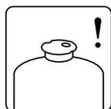
Confirme a ausência de danos, objetos estranhos, sujeira na conexão com válvula
